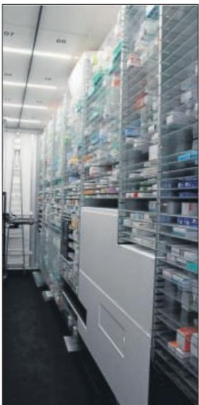
Das neue automatisierte Warenlager ROWA ist größer und schneller.
